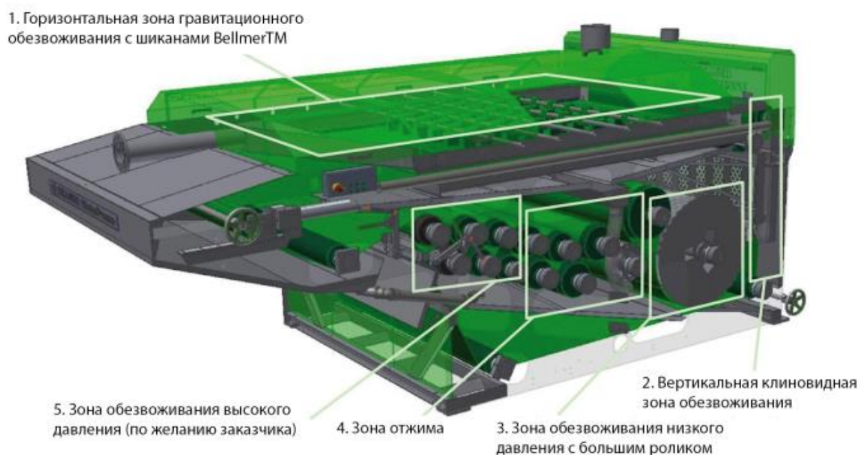
Рисунок 3.8 - Принципиальная схема ленточного фильтр-пресса
